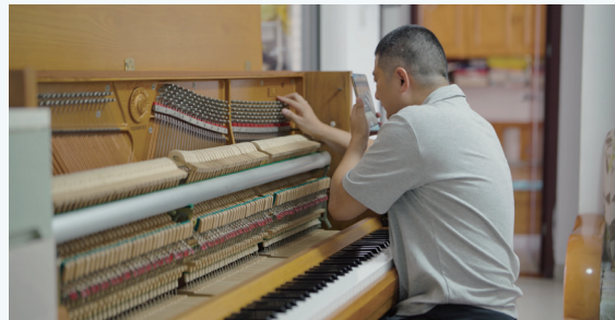
盲人钢琴调律师使用“小艺看世界”功能，通过手机实时获取实景描述，辅助其转动弦轴来拧紧或放松琴弦，调整音律。
