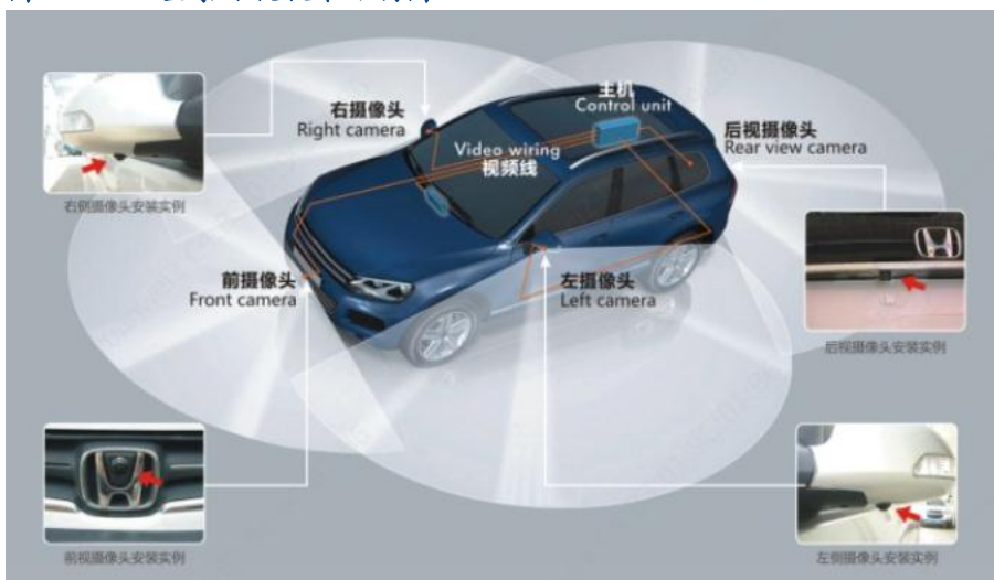
图 56: 360 全景环视技术结构图
