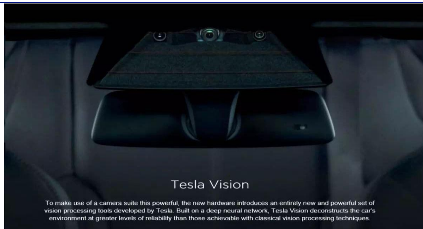
图 21: Autopilot 2.0 转用三目前视摄像头
