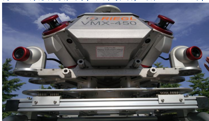
图 36：高德激光雷达车，机械式扫描，造价 800 万人民币 图 37：高精度地图生产趋势
