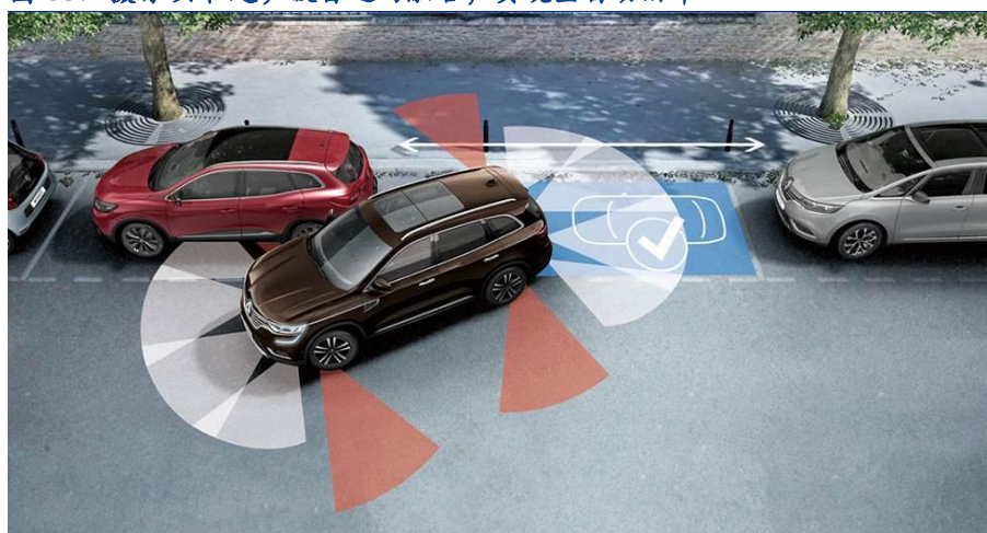
图 58：摄像头和超声波雷达的融合，实现全自动泊车
