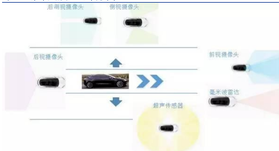
图 13：特斯拉摄像头的种类与布置
