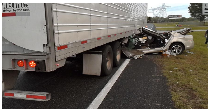
图 20：特斯拉图像识别系统误将白色涂装的卡车识别为白云
