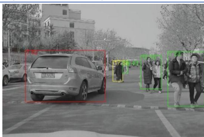
图 17: AI 车载摄像头能够自动识别车辆和行人行进方向和速度
