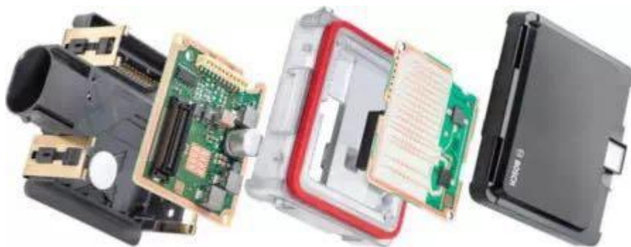
图 23：毫米波雷达的结构图
