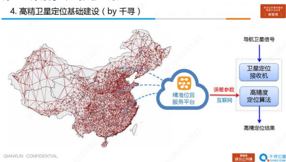
图 46：高精度卫星定位基础设施
