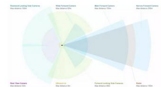
图 8：特斯拉传感器搭载及辐射范围
