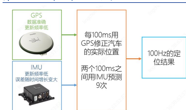
图 43：GNSS (RTK) &IMU 组合
