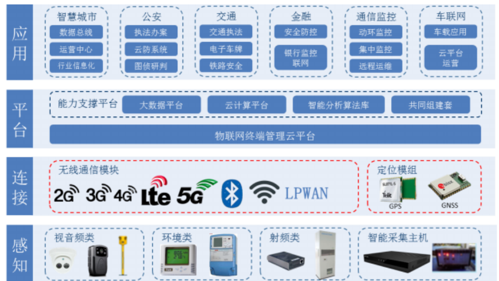
图24: 物联网系统分应用层、平台层、连接层、感知层四个层次
