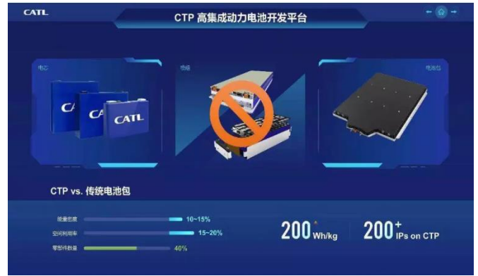
图55: 宁德时代CTP高集成动力电池开发平台介绍
