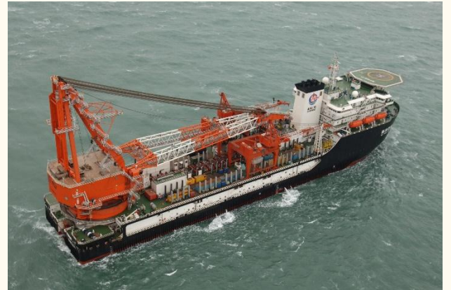
图表 7：公司“海洋石油 201”起重铺管船
