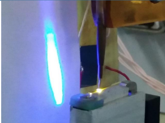
图 32：紫外激光器照到复印纸上形成的蓝色光斑
