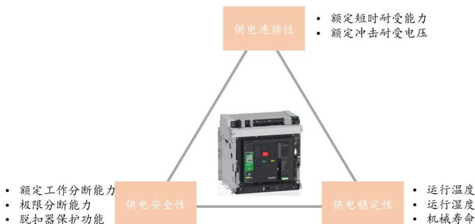
图表4 低压电器对配电系统的安全性有较大影响
