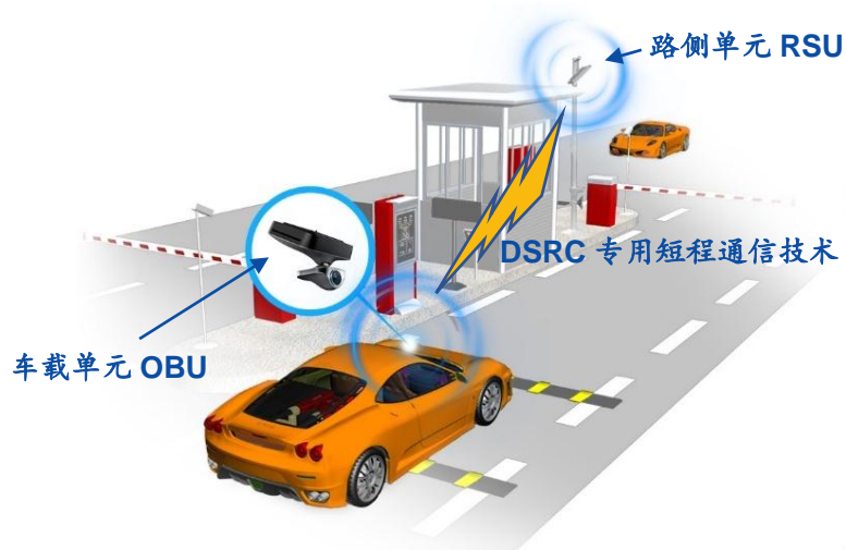
图 9：ETC 基本原理
