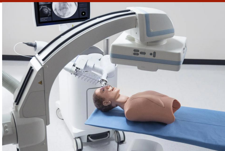
图 17：Ion 机器人肺活检系统
