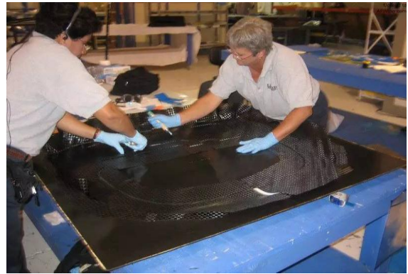
图表12：碳纤维预浸料手动铺叠
