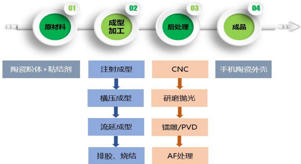
图表 24 陶瓷机壳工艺流程
