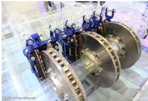
图 14 闸片与制动盘组成一对摩擦副(示意图)
