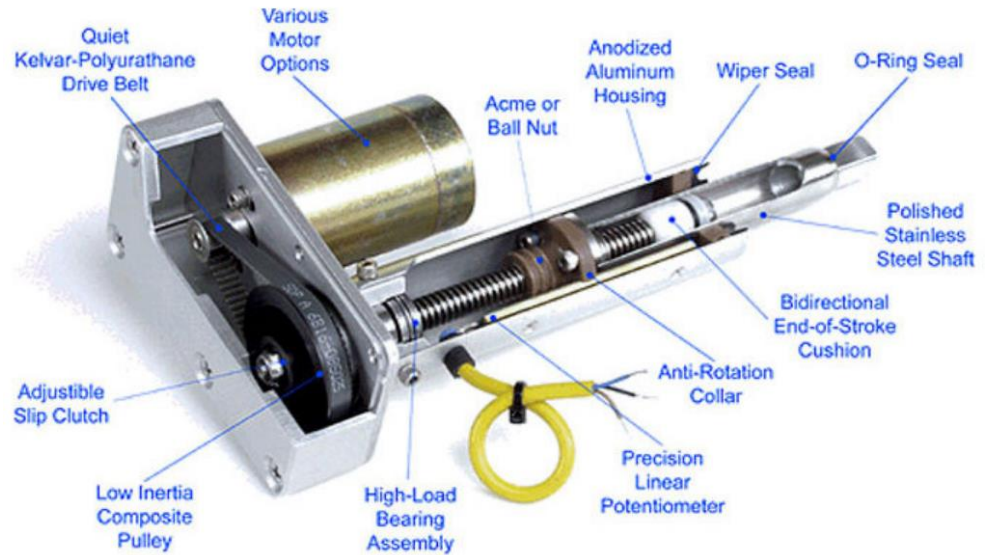
图 10：线性驱动的原理就是把电机的圆周运动转化为推杆的直线运动
