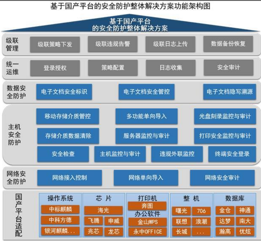
图 15: 基于国产平台的安全防护整体解决方案架构图
