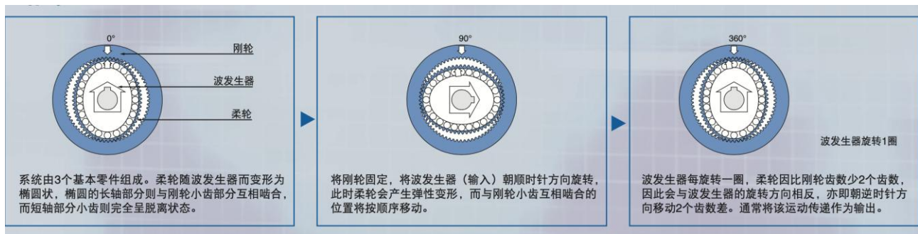
图表18： 谐波减速器通过柔性构件来实现机械传动
