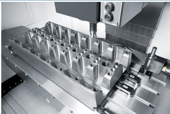
图表31：日本山崎马扎克制造的立式加工中心
