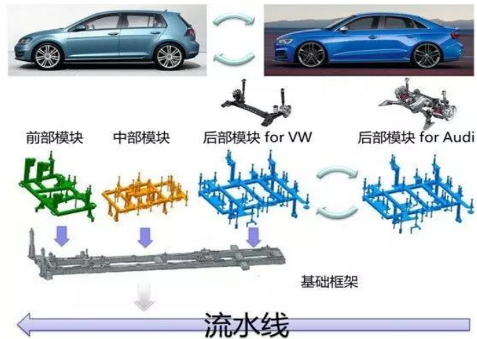
图 8: 生产模具共用示意图
