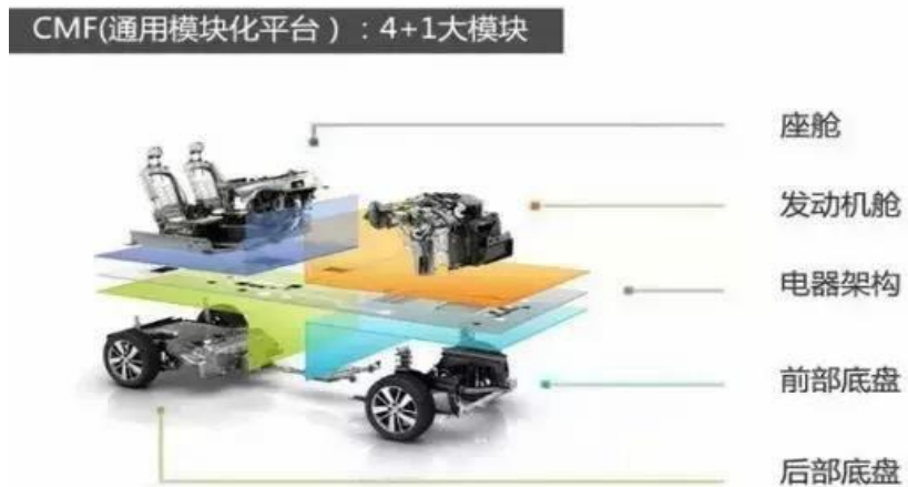
图 19: 雷诺-日产 CMF 模块化平台
