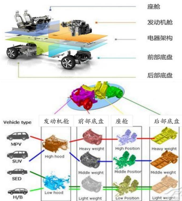
图 6: 模块化平台示意图
