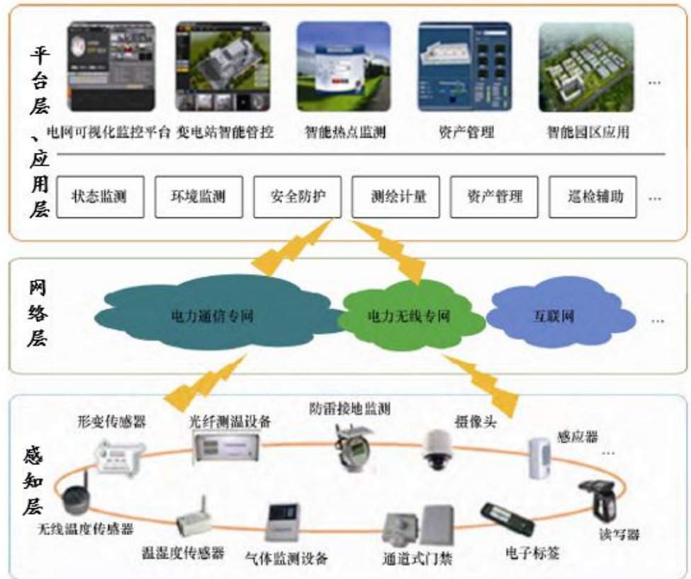
图17 电力物联网网络架构
