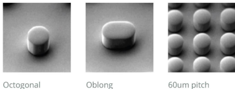
图表40 : Cu Pillar凸块结构
