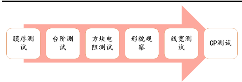
图表17： 集成电路制造阶段涉及多道测试工序
