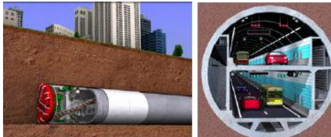
图10 暗挖盾构法综合管廊
