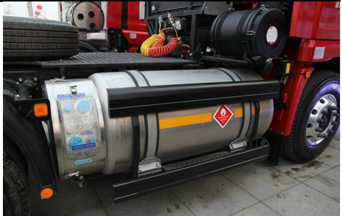
图表47: LNG 气瓶是 LNG 车核心装备
