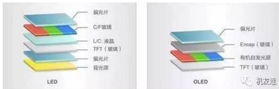
图表 7: OLED 相对于 LCD 结构更为简洁
