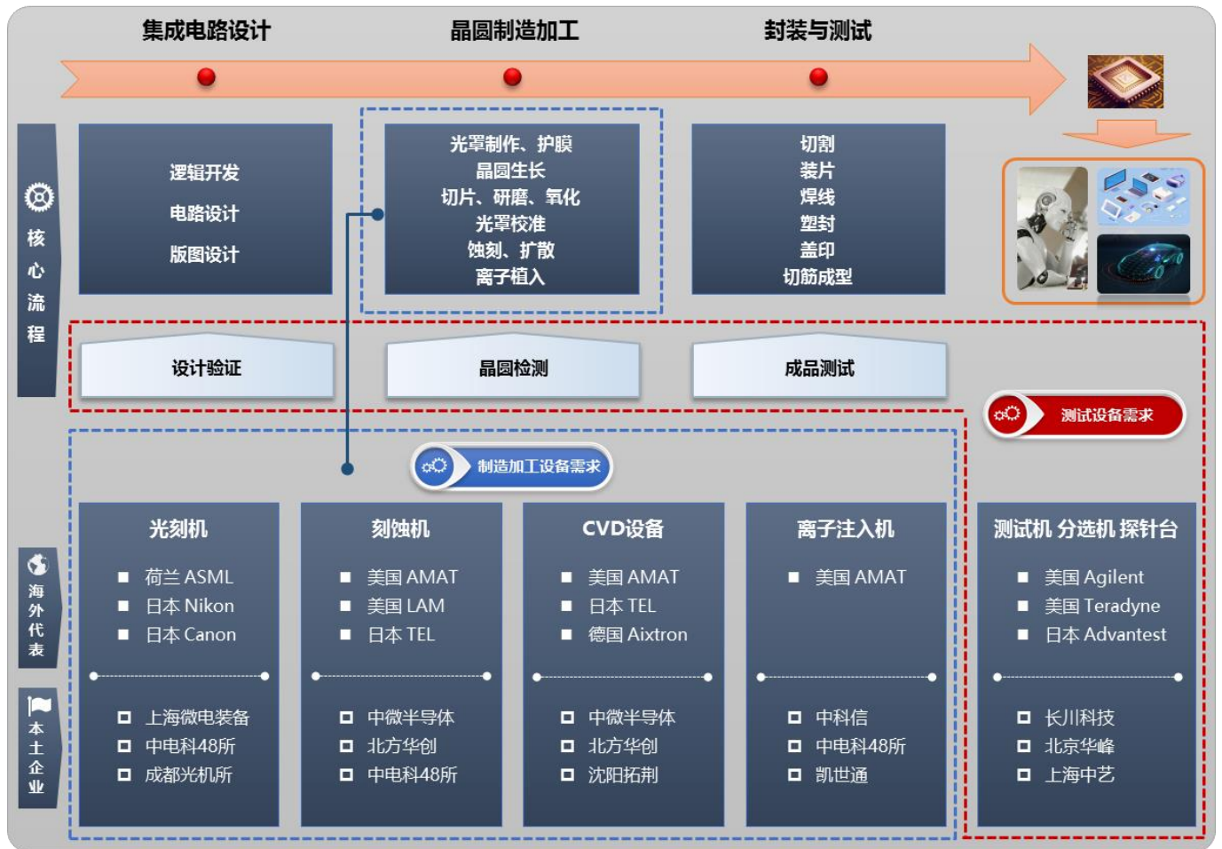
图表8：集成电路主要工艺流程及设备需求一览
