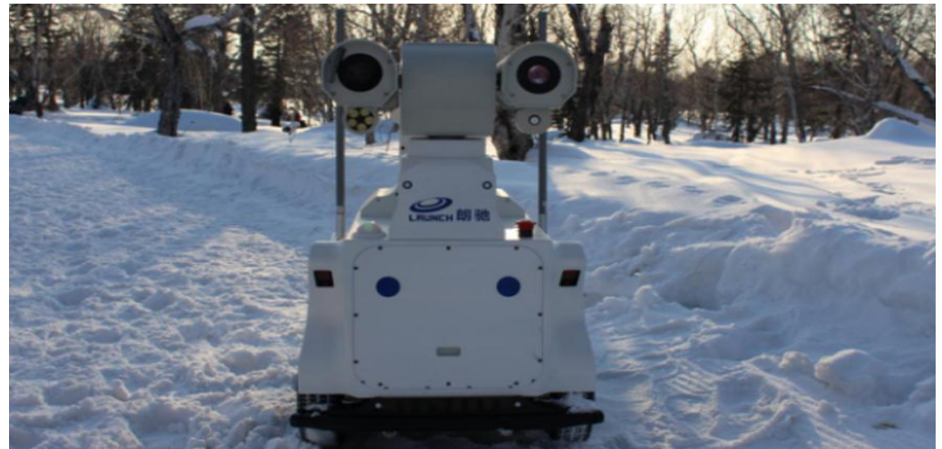
图表45：朗驰新创变电站智能机器人巡检系统
