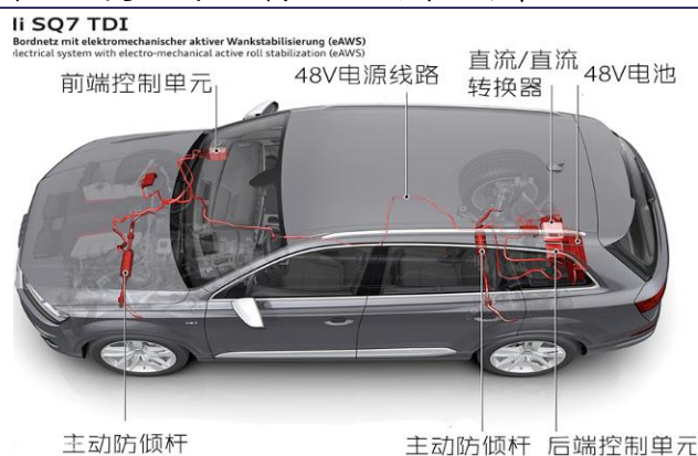
图 35、奥迪 SQ7 搭载 48V 电源系统方案
