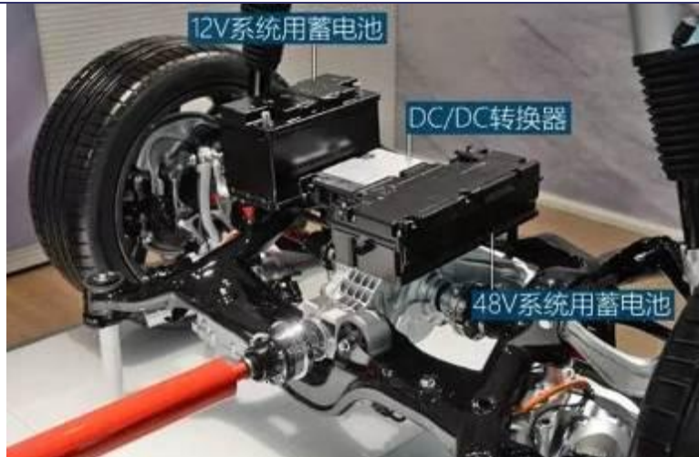
图 36、奥迪 A8 使用 48V 电源为娱乐系统供电
