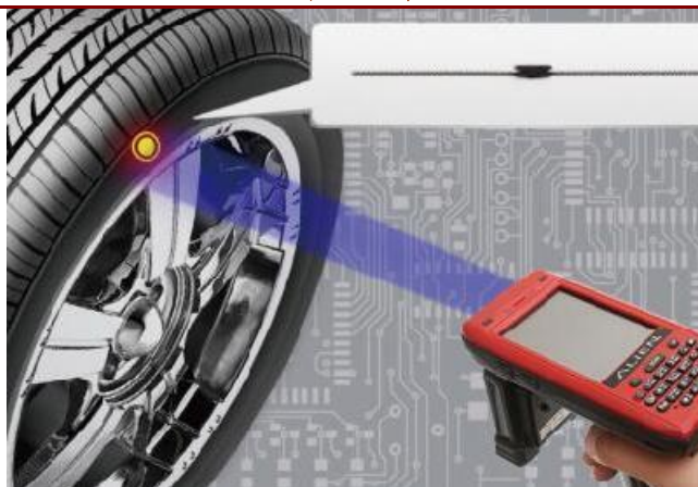
图 11：射频识别 RFID 在轮胎中的应用演示
