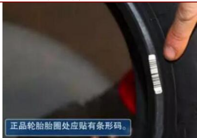
图 10：轮胎条形码在产品上的应用
