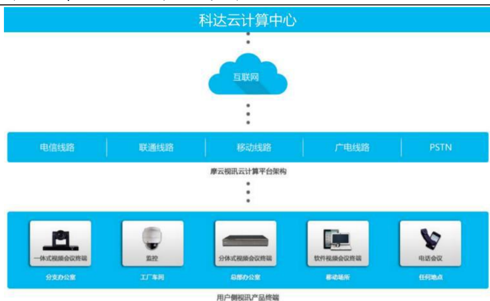
图17：“摩云视讯”会议系统组成结构
