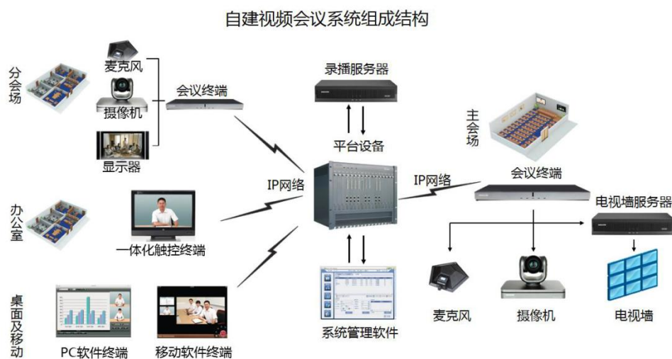
图3：公司自建视频会议系统产品组成结构
