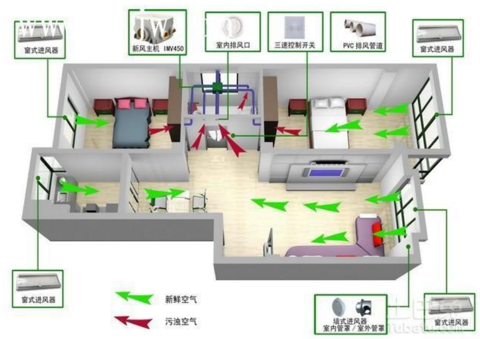
图 11：家庭新风系统原理及所需设备图示
