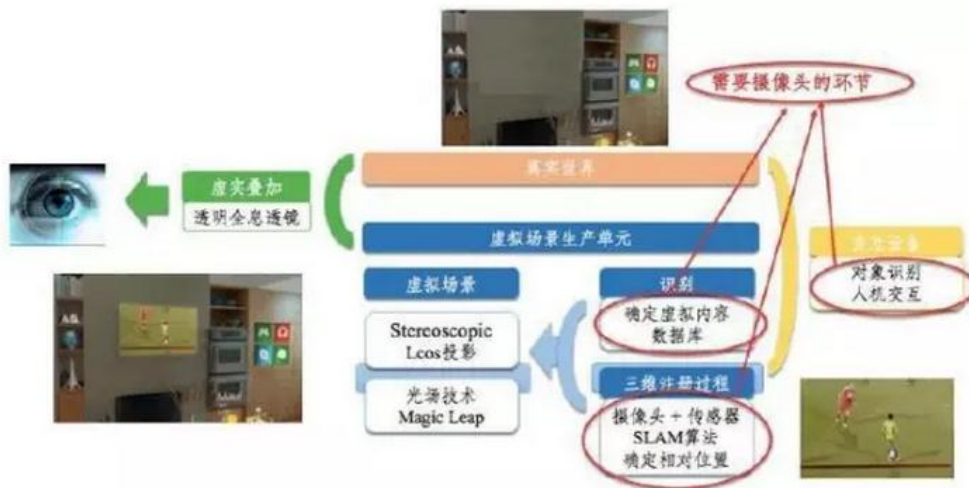
图表12: AR、VR 设备中摄像头的作用
