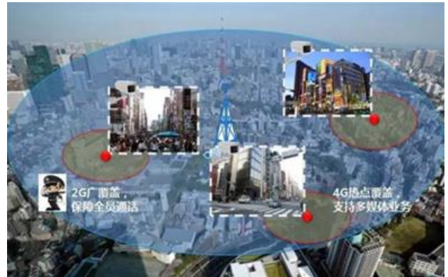
图表44： 2G+4G 混合组网示意图
