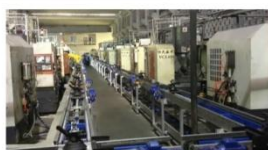
重庆客户10台机器人和25台数控机床组成的柔性加工线
