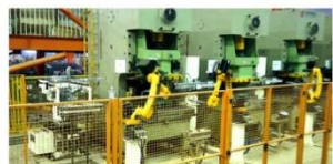
浙江客户8台机器人10台机床组成的刀片打磨生产线
