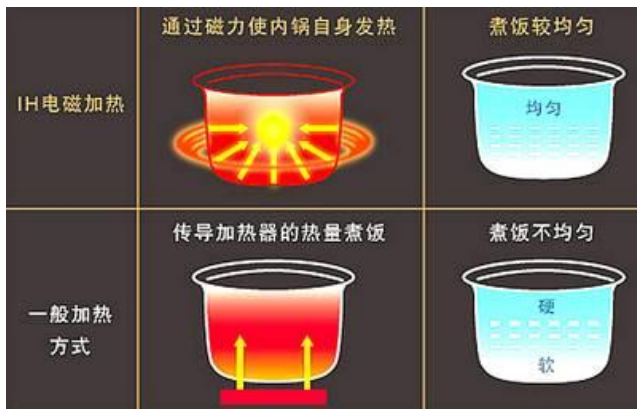
图表 17: IH 电饭煲加热方式和普通电饭煲加热方式
