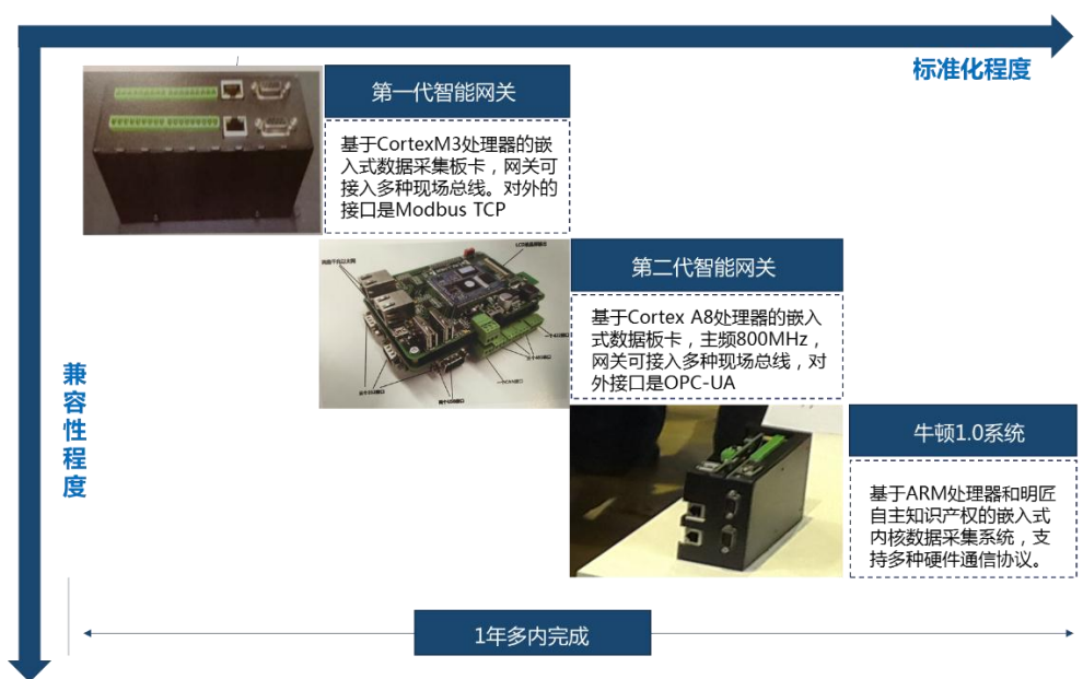
图15: 明匠智能SCADA数据采集系统升级过程
