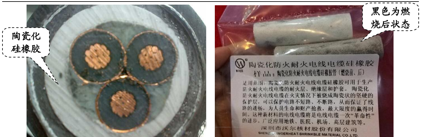
图 7：陶瓷化硅橡胶样品图，材料燃烧后变为陶瓷状保护层，提高线缆安全运行能力
