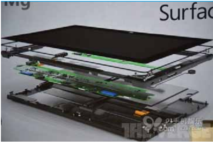
图表19: Windows Surface 采用镁合金机壳
