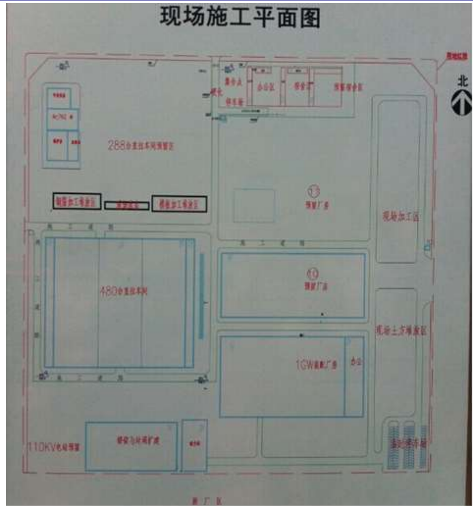
图 14：三期现场施工平面图
