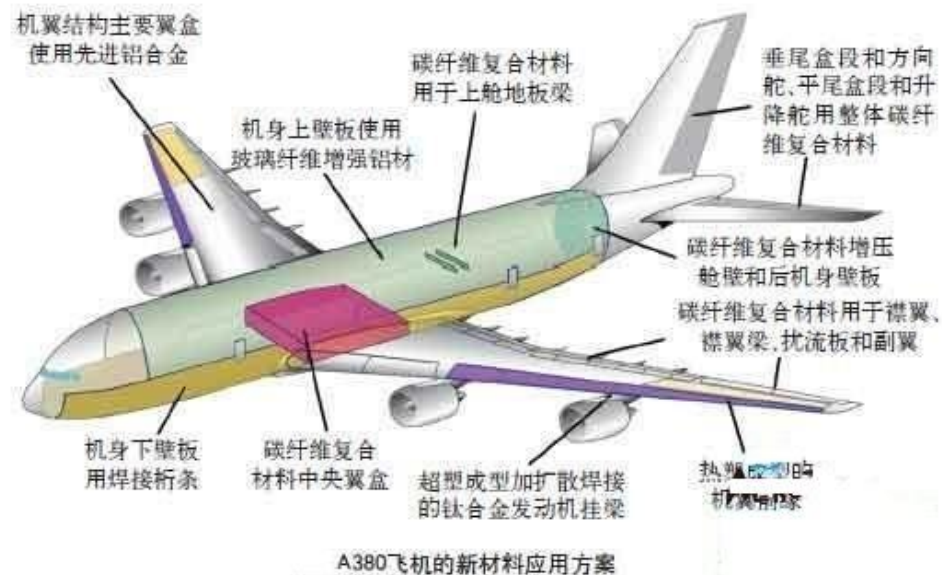
图 12: A380 飞机的新材料应用方案
