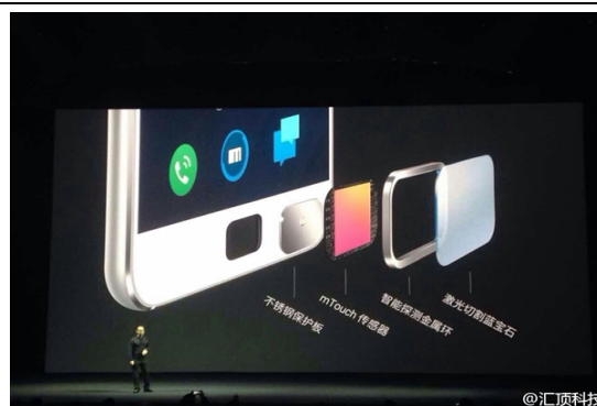
图 2 魅族 MX4 Pro 指纹识别模组构成
